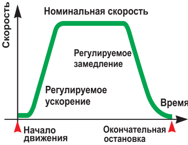
Схема движения лифта с приводом частотного регулирования OVF
